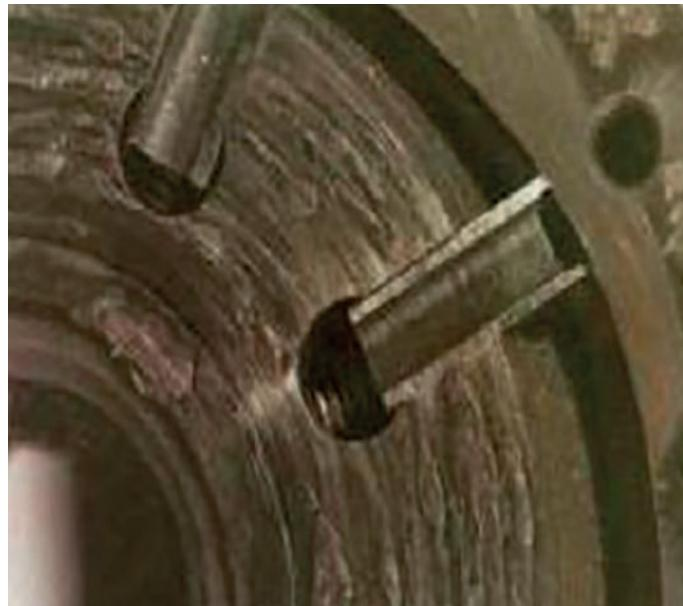
Desgaste prematuro en cuerpo y engranajes de una bomba de engranajes externos
