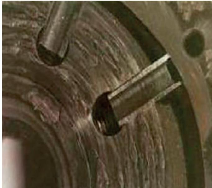
Usure prématuée dans un corps et des engrenages d'une bombe d'engrenages externes.
